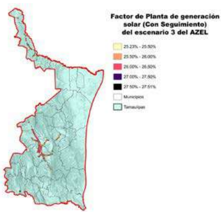
Figura 56. Factor de Planta de centrales con seguimiento en un eje para los polígonos de alto potencial.
